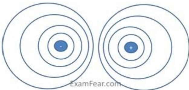
Equipotential surface for a dipole
